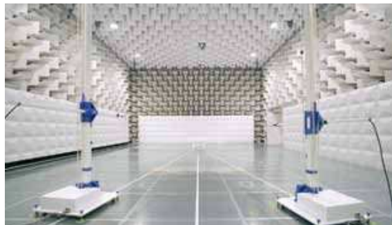
10M法電波暗室
