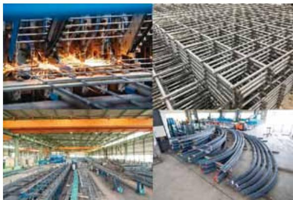
明和町内にある自社工場で、高架道路工事や橋梁工事のコンクリート製構造物の内部に使用される鉄筋部材を加工し、東海・関西地域を中心に事業展開をしています。
