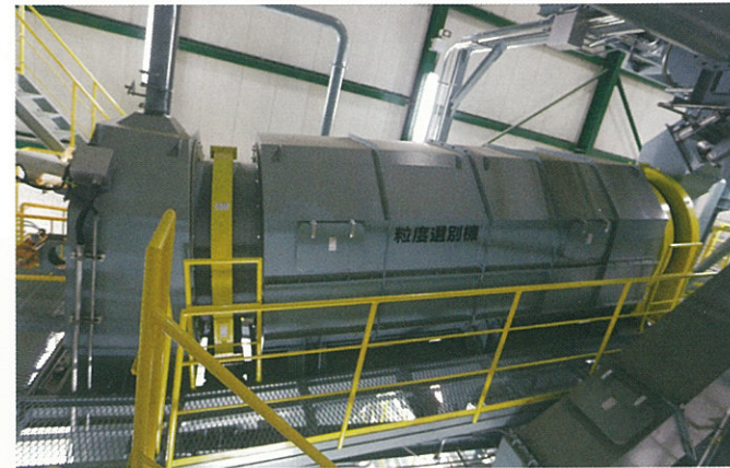
■粒度選別機 破碎物を穴の大きさが異なる円筒の回転式ふるいにかけて、粒度差によって不燃物・可燃物に分別します。
