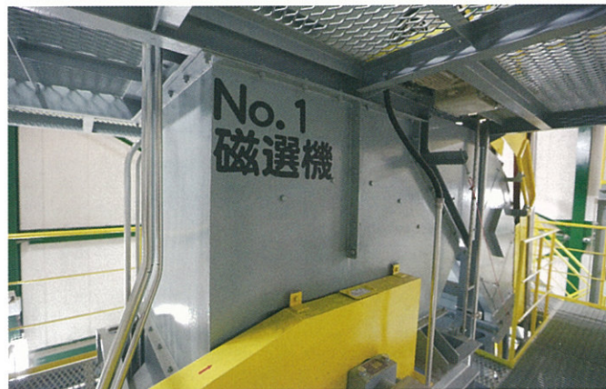
■磁選機 電磁石を使って破碎物の中から破碎鉄を選別します。
