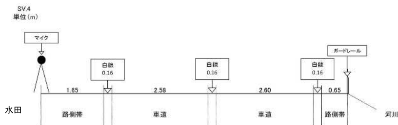
図 7-2-1.3(1) 道路構造断面図 (SV. 3)
