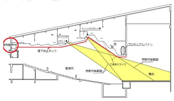
この図がクラギ文化ホールの客席天井から実際にネット施工している会館を 参考にし、落下防止ネットを張った想定図である。落下防止ネットの位置を赤 線で、スポットライトなどを当てることが出来る範囲を黄色で表示し、これを 照射可能範囲と呼ぶ。
