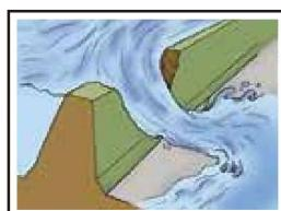
水が増え、水の力で堤防が耐えられなくなり、堤防の一部が崩れ始めます。
