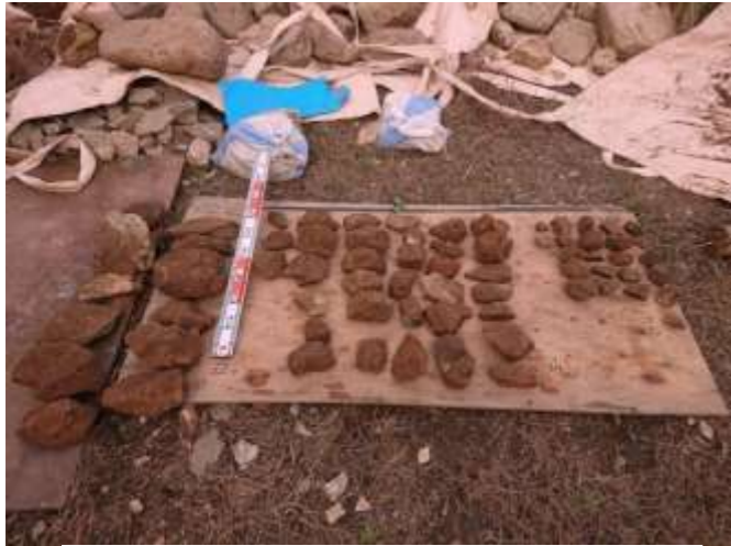
裏込石の粒径・密度調査の様子
