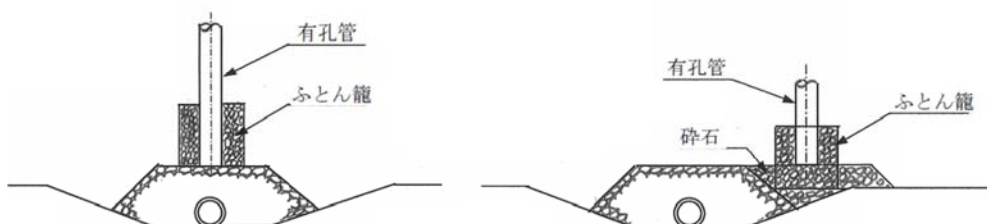
図6-7-13 豎形集排水管の構造例
