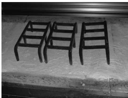
六価クロムの発生要因 ステンレス製のロストル
