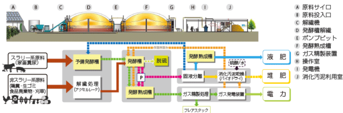
図5 バイオガス発電システムの一般的な概要
