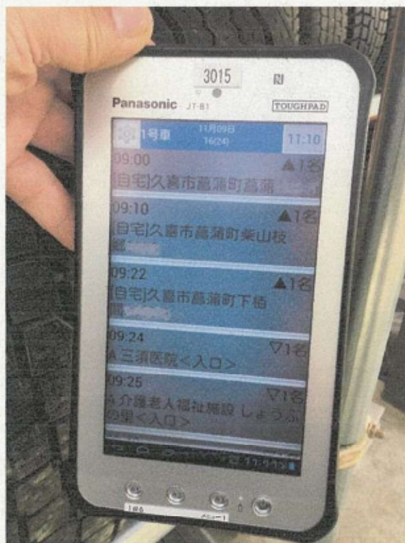
運転手用携帯端末（訪問先順序、乗降人数等が表示される）
